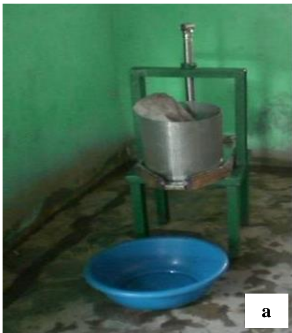
Figures 3a et 3b : Différents types de presse : Presse à vis (a) et presse hydraulique (b)
