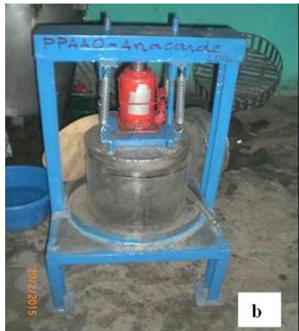
Figures 3a et 3b : Différents types de presse : Presse à vis (a) et presse hydraulique (b)
