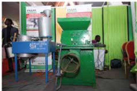
Table de traitement de l'huile d'arachide (à gauche) et machine de placement profond de l'urée (à droite)
